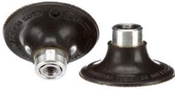
Gummistützteller mit Metallgewindekern und integrierter 1/4“-Aufnahme zum direkten Einsatz auf 3M™ Roloc™ Winkelschleifern. Die Abmessung ist entsprechend dem Durchmesser des Schleifwerkzeugs zu wählen. Speziell geeignet zum Einsatz mit Bristle Discs, Vlies-, Schleif- und Fiberscheiben mit 3M™ Roloc™ Schnellwechselsystem.
