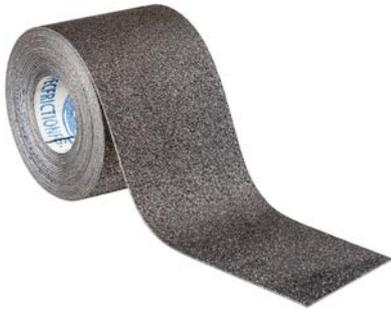
Der 3M™ Gleitbelag 165 ist ein mit Graphit beschichtetes, starkes Gewebeprodukt, um Schleifschuhe und Kontaktplatten zu belegen. Bedingt durch die Beschichtung wird die Reibwärme beim Schleifen reduziert.
