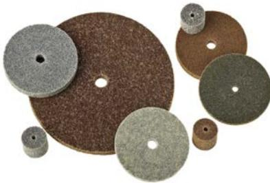
Bei der Scotch-Brite™ Kompaktscheibe XL-UW handelt es sich um verpresstes Faservliesmaterial, welche beste Finish-Eigenschaften mit Aggressivität und einer hohen Standzeit verbindet. Das Material passt sich aufgrund seiner Federwirkung und Flexibilität ideal an jedes Werkstück an, verändert die Geometrie des Werkstücks nicht und sorgt zusätzlich für verringerte Vibrationen und eine verbesserte Anwenderergonomie im Anwendungsprozess.
