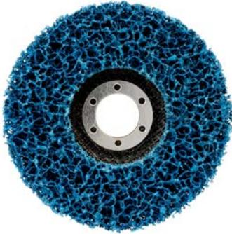
Das Scotch-Brite™ Grobreinigungsmaterial „Clean and Strip General Purpose“ (CG) ist flexibler als das Grobreinigungsmaterial „XT“, ist jedoch ebenso aggressiv. Die Scotch-Brite™ Grobreinigungsscheibe CG-RD hat einen eingearbeiteten Glasfibrerträger und direkt ohne weiteres Zubehör auf einem Winkelschleifer eingesetzt werden.
