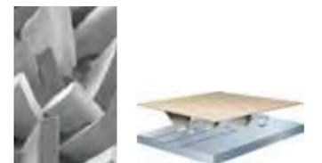
Konstruiertes 3M™ Cubitron™ II Korn
