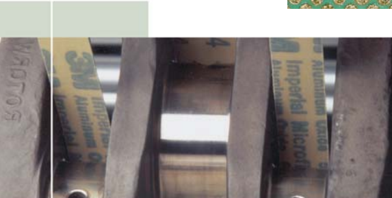
Microfinishing an einer Kurbelwelle zur Erreichung eines speziellen Ra Wertes
